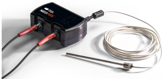
Figure 3 : Bien que conçu pour la détection de la fluorescence sensible à l'oxygène, le fluorimètre de phase NeoFox peut mesurer les propriétés de désintégration rapide de colorants fluorescents utilisés dans le diagnostic médical.
